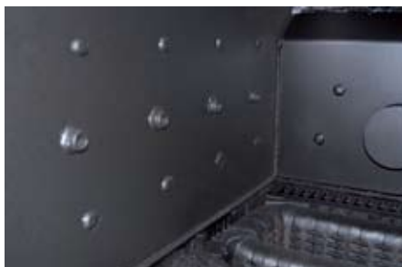
Orificii aer post-combustie
